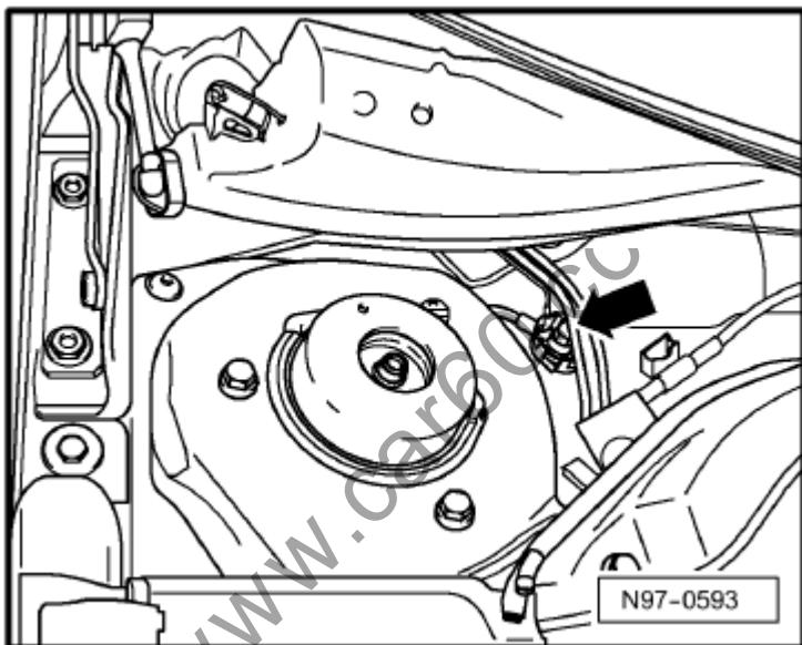
640 发动机舱左侧接地点 -箭头A-
