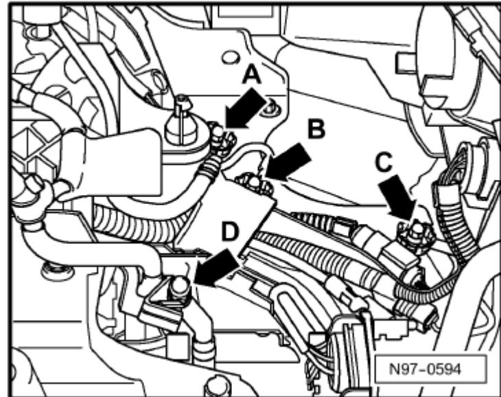
652 变速箱/发动机的接地点 -箭头D-
